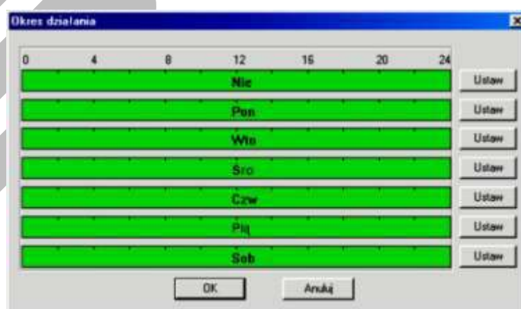
Rys. 7-38a. Ustawianie okresu aktywności wejścia alarmowego.
